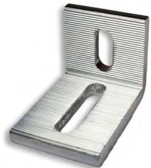
**z.B. zur Montage von Schienensystemen mit unten liegendem oder seitlichen Schraubkanal auf den S-5!® Klemmen mit M8-Gewinde. Wird zur Montage eine M8x16 Edelstahlschraube mit Sperrverzahnung im oberseitigen M8-Gewinde verwendet, ist diese mit einem Drehmoment von 18 Nm anzuziehen.**
