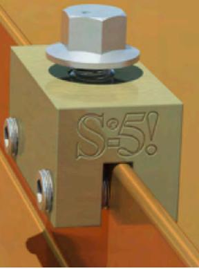
Die B-Klemmen aus Messing mit einem Öffnungsschlitz von 6mm sind speziell für Kupferdächer mit Doppelstehfalz geeignet.
